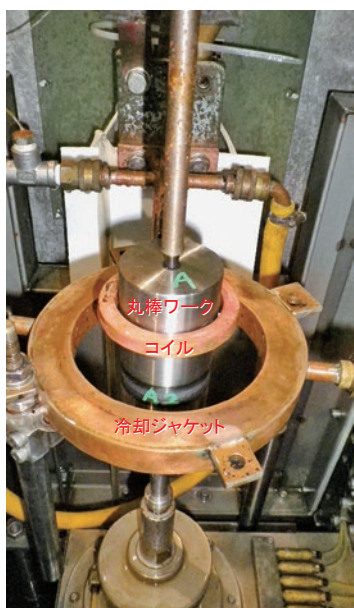
写真 4 1 ターンコイル
